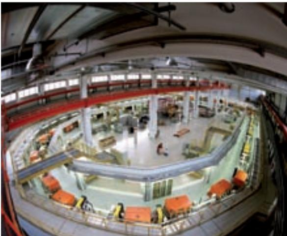
Das Küblersynchrotron COSY beim Forschungszentrum Jülich besteht aus einem Synchrotron, in dem Protonen oder Deuteronen beschleunigt werden, einem Speicherring und mehreren Experimentiereinrichtungen für Untersuchungen im Bereich der Hadronenphysik. COSY zeichnet sich vor allem durch die so genannte Strahlkühlung aus, bei der die Abweichung der Teilchen von ihrer vorgegebenen Bahn durch Elektronen- bzw. stochastische Kühlung reduziert wird.
