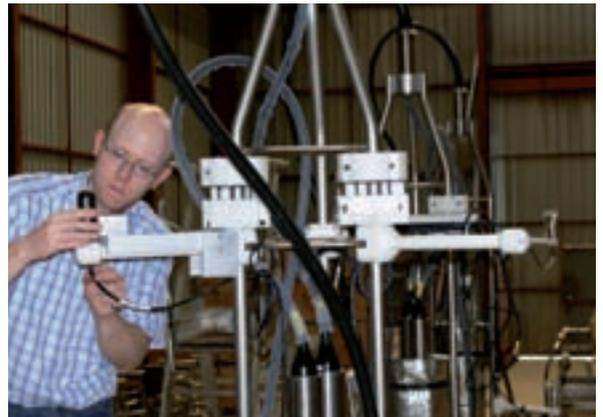
Ein Mitarbeiter des ECAP montiert ein Hydrophon auf ein akustisches Stockwerk von ANTARES. Diese Hydrophone, in Erlangen entwickelt, spüren die akustischen Signale auf, die von den Neutrinos im Wasser erzeugt werden.
