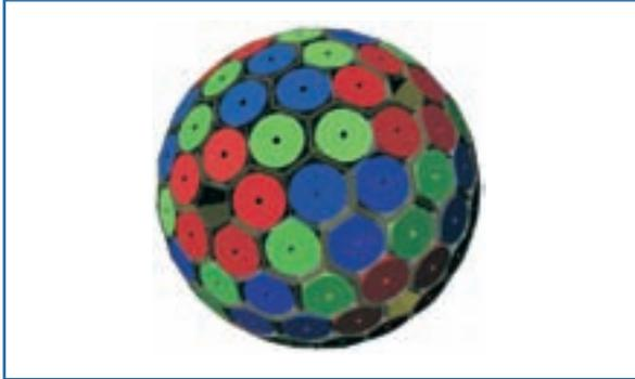
Das Gammaskpektrometer AGATA ermöglicht erstmals eine lückenlose Abdeckung des vollen Raumwinkels mit Detektoren. Seine Leistungsfähigkeit übertrifft die bisheriger Geräte für die Kernspektroskopie um mehrere Größenordnungen.
