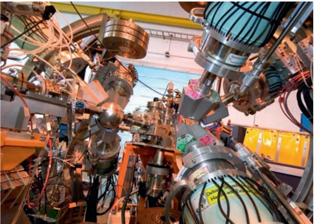
MINIBALL am CERN ist ein Gammaskpektrometer, das speziell für die Untersuchung exotischer Kerne eingesetzt wird. MINIBALL besteht aus 24 sechsfach segmentierten, gekapselten Germaniumdetektoren, die in Einheiten zu je drei Detektoren in einem gemeinsamen Kryostaten zusammengefasst sind. Der untersuchte Strahl stammt vom Beschleuniger REX-ISOLDE.
