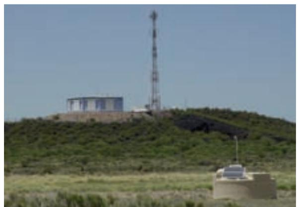
Das Pierre-Auger-Observatorium ist ein Hybrid-Detektor. Im Vordergrund sieht man einen der 1600 Wassertanks zum Nachweis von Sekundärteilchen aus der kosmischen Strahlung, auf dem Hügel steht einer der Fluoreszenzdetektoren.
