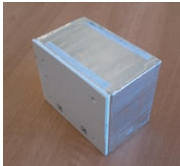
Ein einzelner Sensor des OPERA-Detektors, dem Kernstück des Neutrinoexperimentes, enthält 56 Blei- und 57 Photoplatten. Der gesamte Detektor besteht aus 155.000 solcher Sensoren.
