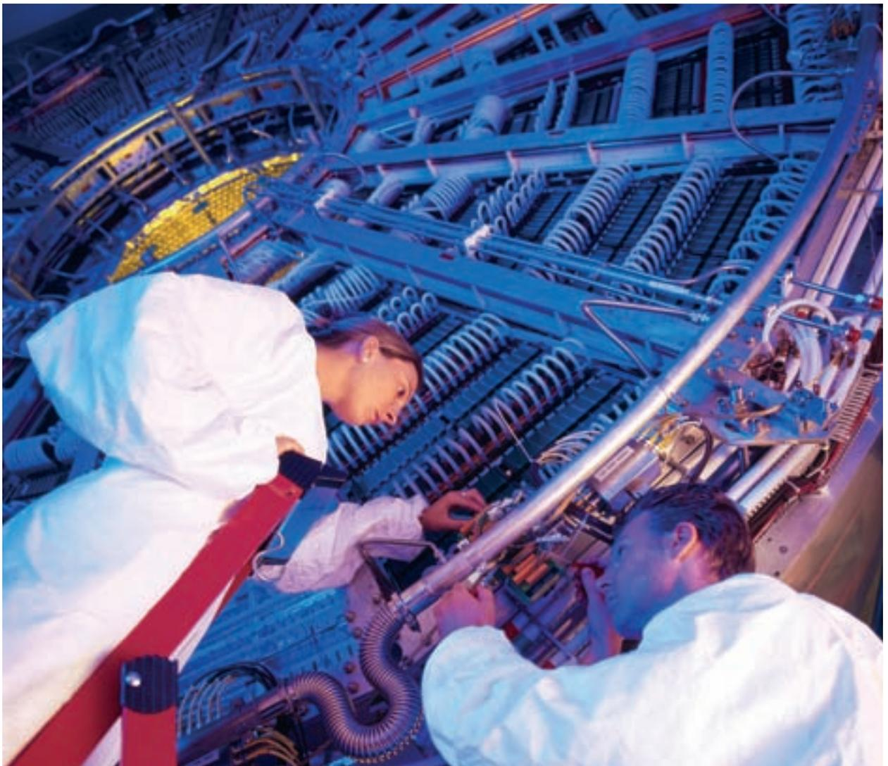
Die Time Projection Chamber (TPC) ist der Teil von ALICE, in dem hauptsächlich die Teilchenbahnen bestimmt werden. Die geladenen Teilchen ionisieren das TPC-Füllgas und erzeugen freie Elektronen, die über die angelegte Spannung „abgesaugt“ werden. Daraus lässt sich die Teilchenbahn rekonstruieren.
