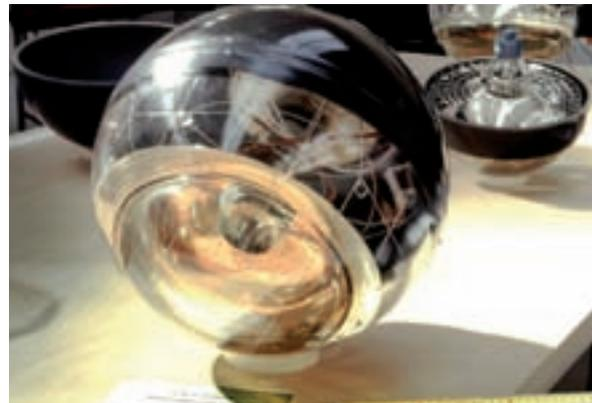
Die Glaskugeln, in denen sich die Photosensoren befinden, müssen einem Druck von ca. 250 bar standhalten, der in der Meerestiefe von 2500 Metern herrscht.
