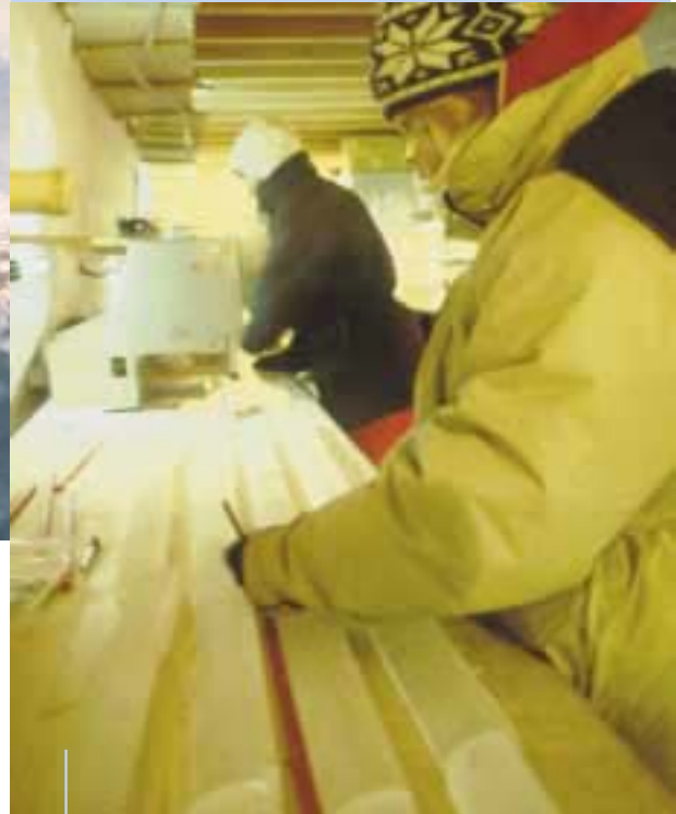
▼ ANALYSE VON EISBOHRKERNEN AUF GRÖNLAND. DER RAUM WIRD NICHT BEHEIZT, DAMIT DIE WERTVOLLEN UNTERSUCHUNGSOBJEKTE NICHT SCHMELZEN. (FOTO: A. GERDES, MARUM)
