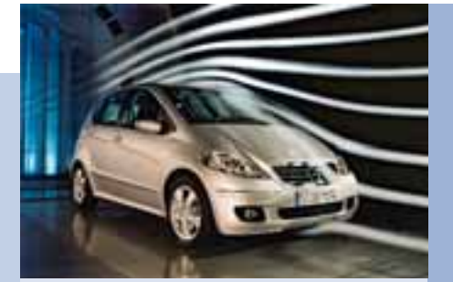
Bei 100 km/h schluckt der Luftwiderstand etwa 2/3 der Motorleistung eines Mittelklasse-Wagens. Mit Hilfe des Windkanals können die Strömungsverhältnisse optimiert werden. Bild: DaimlerChrysler
