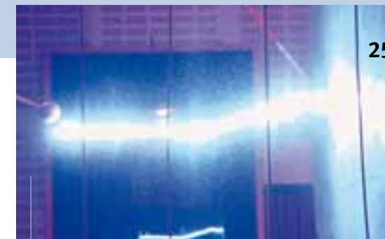
↔ Bei einem Labor-Experiment lenkt ein intensiver (unsichtbarer) Laserstrahl einen ansonsten umherzuckenden Blitz in eine vorbestimmte Bahn. Bild: Kamil Stelmaszczyk, FU Berlin
