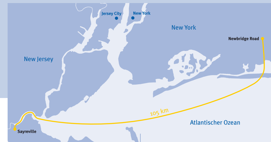
📍 Per Seekabel bezieht die amerikanische Halbinsel Long Island Strom aus dem Netz von New Jersey. Die Hochspannungs-Gleichstrom-Leitung steht unter 500.000 Volt. Bild: Siemens
