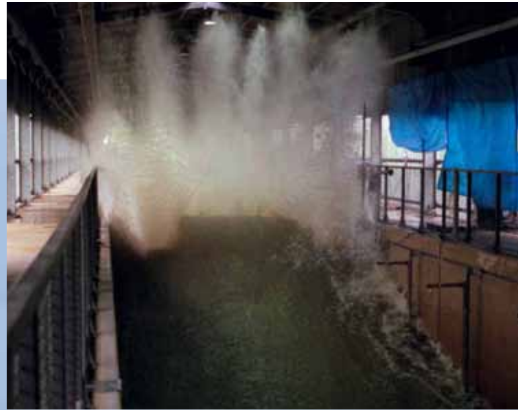
☞ Forscher der TU Berlin lassen Miniaturausgaben der „Freak Waves“ zu Testzwecken auf einen Wellenbrecher krachen. Dazu schicken sie lange, schnelle Wellen langsam vorauslaufenden kurzen Wellenbergen hinterher. (Bild: Meerestechnik - Technische Universität Berlin)
